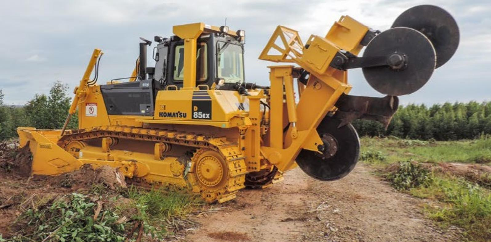
O D85 é o primeiro trator de esteiras totalmente configurado na fábrica para uso no preparo de solo. O trator, com motor de 266 HP, tem o porte ideal para este tipo de operação, obtendo assim um menor consumo de combustível. O material rodante de carro longo, com oito roletes inferiores em cada lado, permite melhor distribuição da pressão, proporciona mais tração e facilidade de deslocamento pelo talhão. Com reposicionamento dos joysticks a ergonomia operacional é ampliada.
