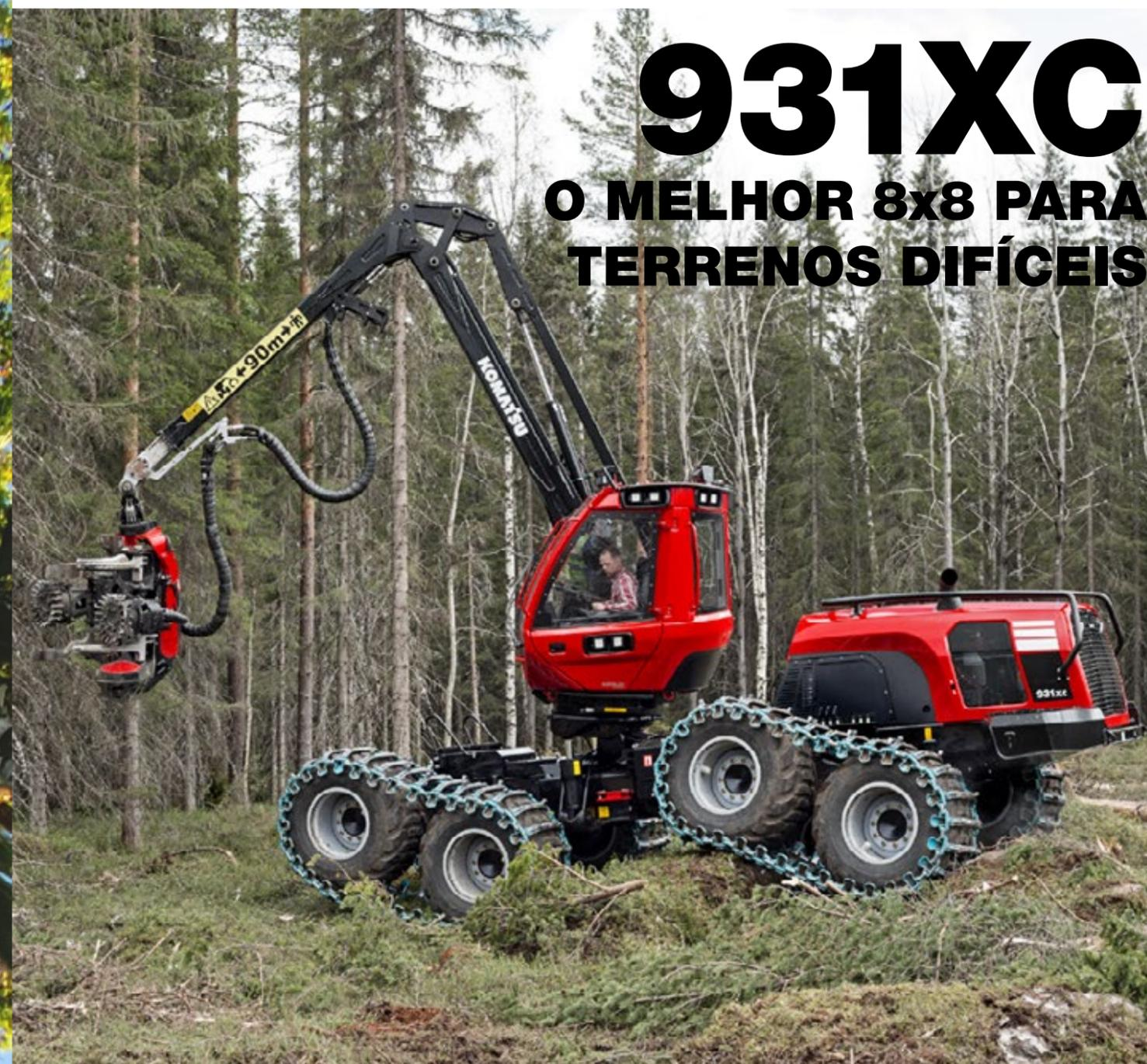
O Komatsu 931XC é um harvester potente com tração nas oito rodas. Oferece estabilidade, baixa pressão no solo e é excelente em terrenos difíceis. Com exclusiva tecnologia de três bombas hidráulicas permite ao operador executar várias funções simultaneamente sem perda de potência hidráulica, como girar a grua enquanto alimenta uma tora e manobra a máquina. Tudo isso com baixo consumo de combustível.
