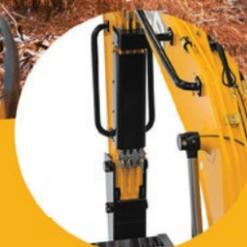
PONTEIRA PLUG AND PLAY PARA CABEÇOTE HARVESTER, LINHAS HIDRÁULICAS DE ALTO FLUXO
